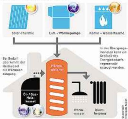
Eine Hybridheizung nutzt immer die effizienteste Energiequelle für die Wassererwärmung. In den Übergangszeiten bringt das große Einsparungen. Foto: djd/VdZ
